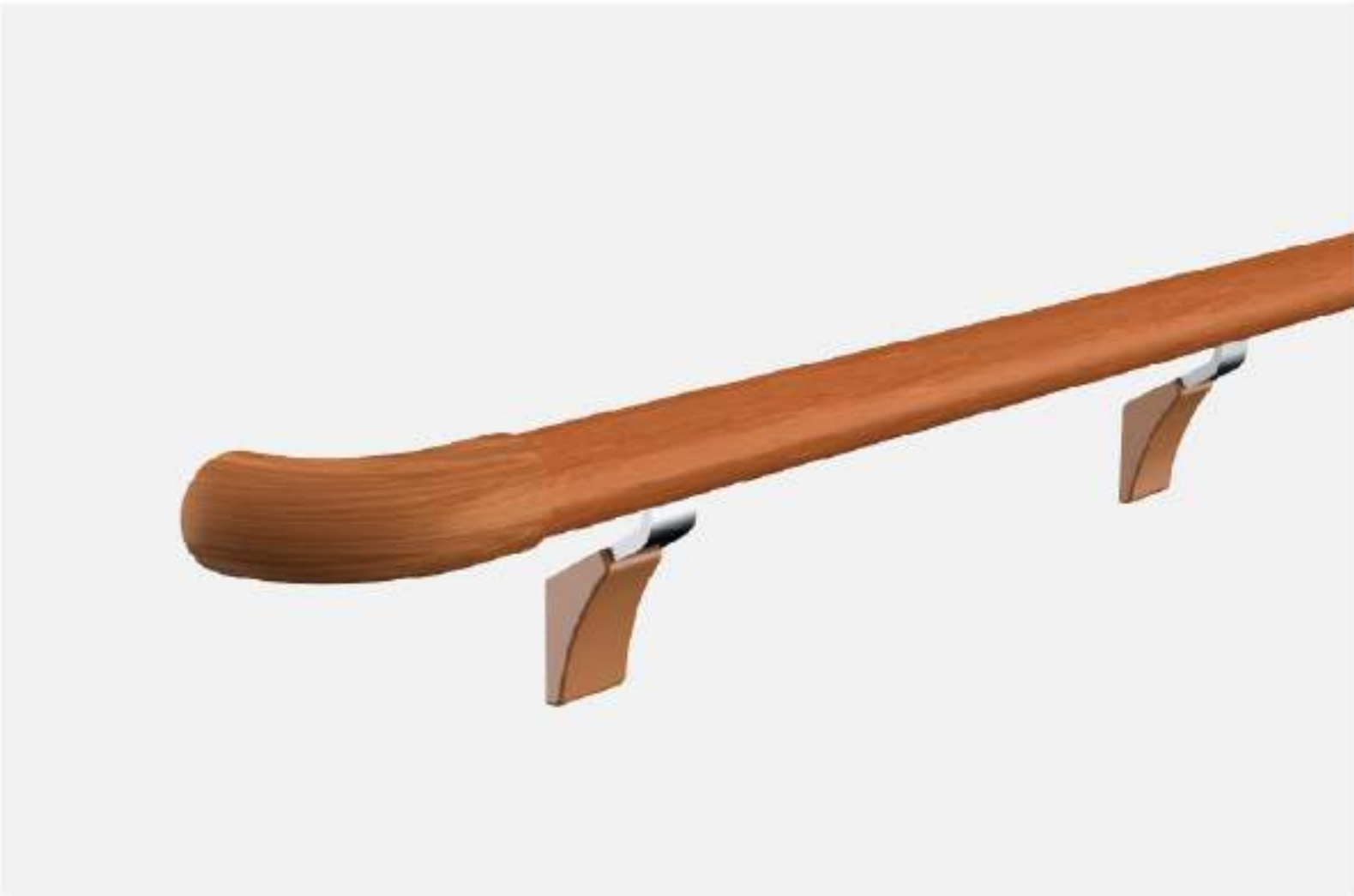
HS-646A 防护扶手 产品材质: 胶管+铝镁合金 产品管径: 40mm 表面处理: 赤檀木纹树脂光面胶管
